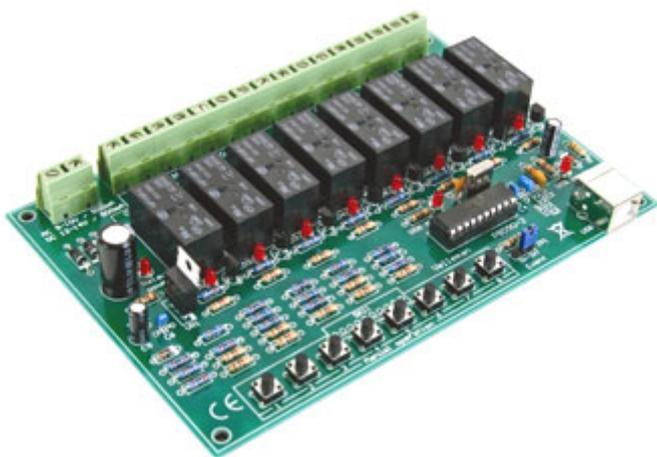
Questa scheda consente di attivare e disattivare, manualmente o tramite PC, un carico resistivo di 16 A (max) su ciascuno dei suoi otto relè. Funzionamento monostabile e bistabile (selezionabile tramite software). Possibilità di inserire un soppressore di disturbi (non compreso) per carichi induttivi.
