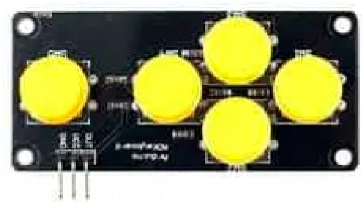
Semplice scheda con 5 pulsanti e uscita analogica. Alla pressione di ognuno dei 5 pulsanti si ottiene una tensione differente in uscita. Adatta per essere utilizzata in abbinamento con Arduino, Fishino o altro. Alimentazione: 5 volt.
