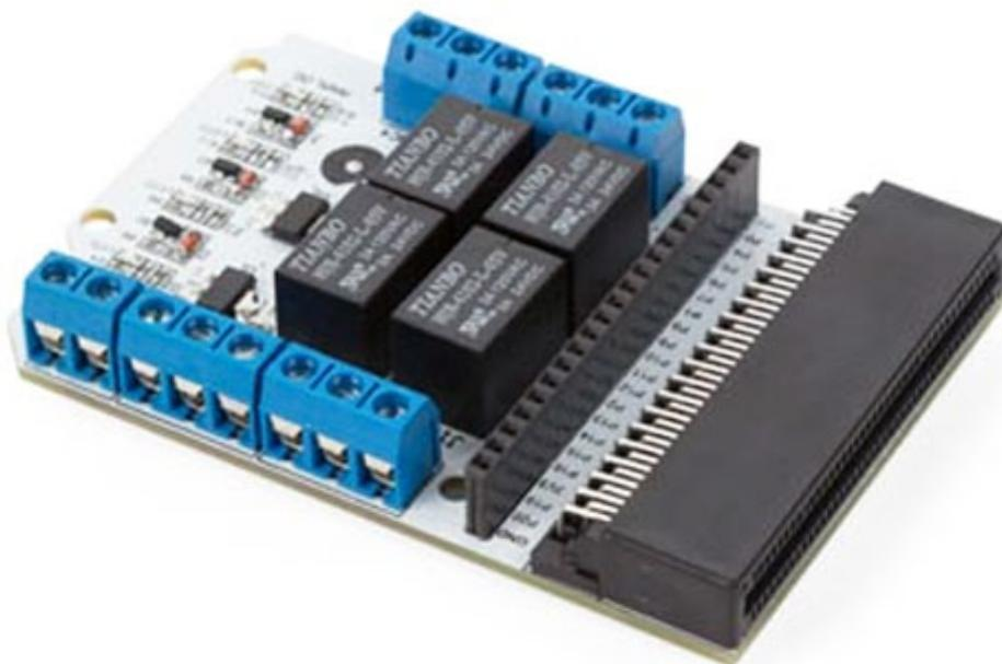
Piccolo modulo per **micro:bit** dotato di 4 relè di elevata qualità in grado di supportare carichi (non induttivi) fino a 24 VDC / 3 A, LED per l'indicazione dello stato dei relè, morsettiere a vite per i contatti (NO/NC/C) dei relè e per l'ingresso di alimentazione. Alimentazione: da 3,3 a 5 VDC, dimensioni (mm): 80x57x15, peso: 55 grammi.
