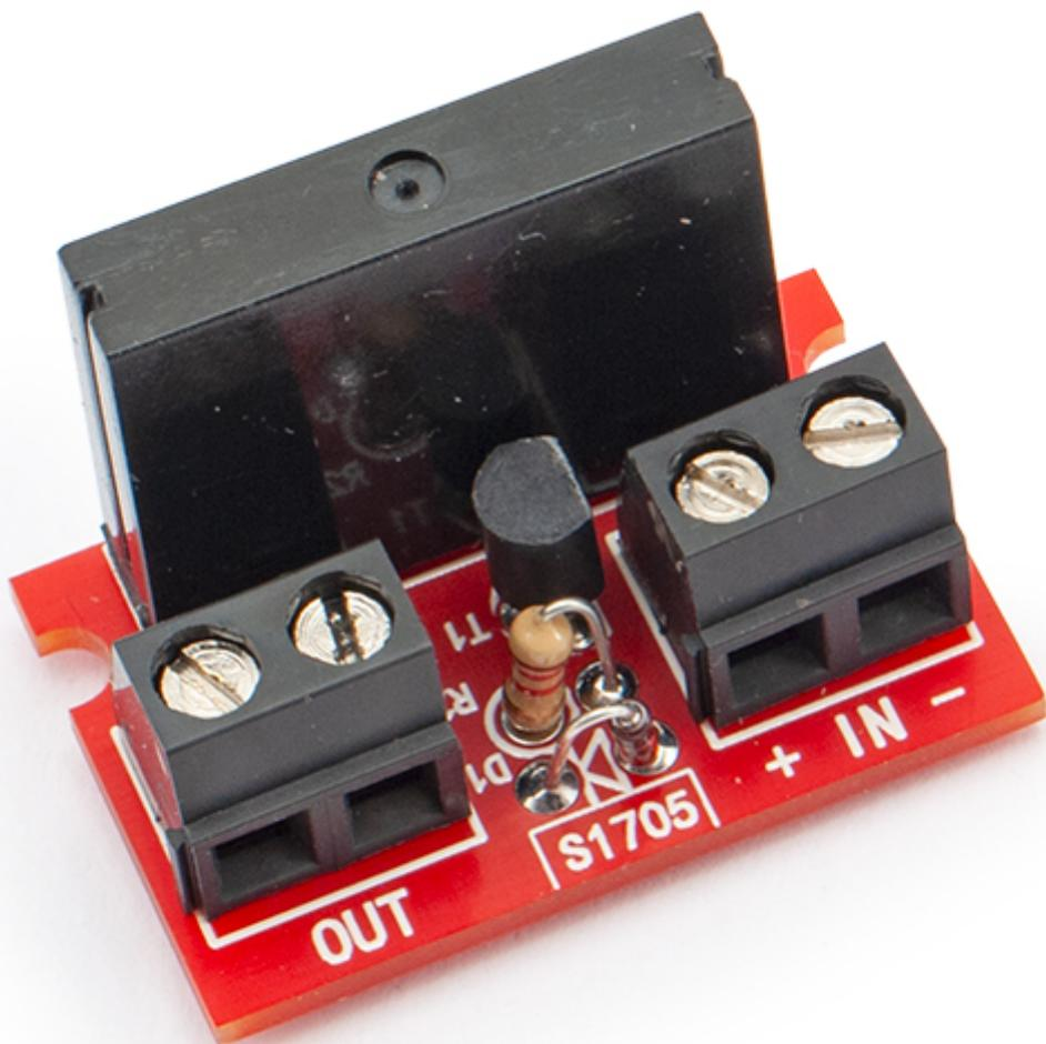
Questa scheda relè è progettata per essere controllata con una tensione in ingresso compresa tra 5 Vdc e 24 Vdc. Consente di attivare o disattivare un carico collegato a 240 Vac con una corrente massima di 2 A.
