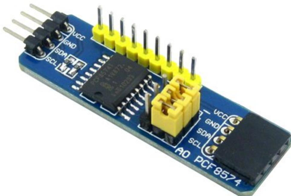
Basata sul chip I/O expander a 8 bit PCF8574, questa piccola scheda, dotata di connettore maschio I<sup>2</sup>C da un lato e femmina dall'altro, permette di espandere fino a 64 il numero di I/O di un microcontrollore. È inoltre possibile collegare più moduli in cascata. Dimensioni (mm): 55x16x11, peso: 4 grammi.
