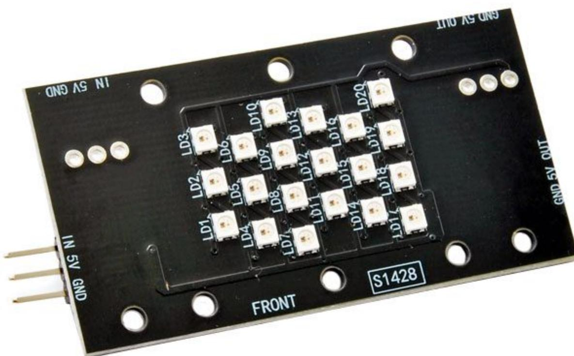
Scheda elettronica con 20 LED Neopixel in miniatura (2,4x2,7x1,1 mm) e connettori con pin di alimentazione e bus di comunicazione. Indicato per essere utilizzato con i display Nixiel (non compresi, vedere prodotti correlati). Alimentazione: 5 VDC, dimensioni (mm): 57x30x3,5, peso: 5 grammi. **Attenzione!** le parti in plexiglass tagliate a LASER, necessarie per completare il display Nixiel, non sono comprese.
