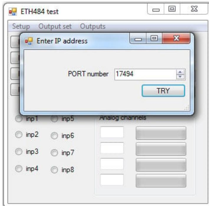
Per fare un test è necessario un computer dotato di una connessione Internet e non connesso alla stessa rete della scheda ETH484. Effettua il download ed esegui il programma di test sotto riportato e seleziona l'indirizzo IP impostato. Nella finestra di pop-up inserisci l'indirizzo IP per l'accesso da internet. Fai click su "Try IP" e ti conatterai all'interfaccia ETH484 come se tu fossi all'interno della rete.
