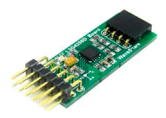
Giroscopio a 3 assi basato sul chip L3G4200D della STMicroelectronics. Dispone di interfaccia l<sup>2</sup>C/SPI e supporta anche il collegamento in cascata di più moduli collegati al bus l<sup>2</sup>C nello stesso tempo.
