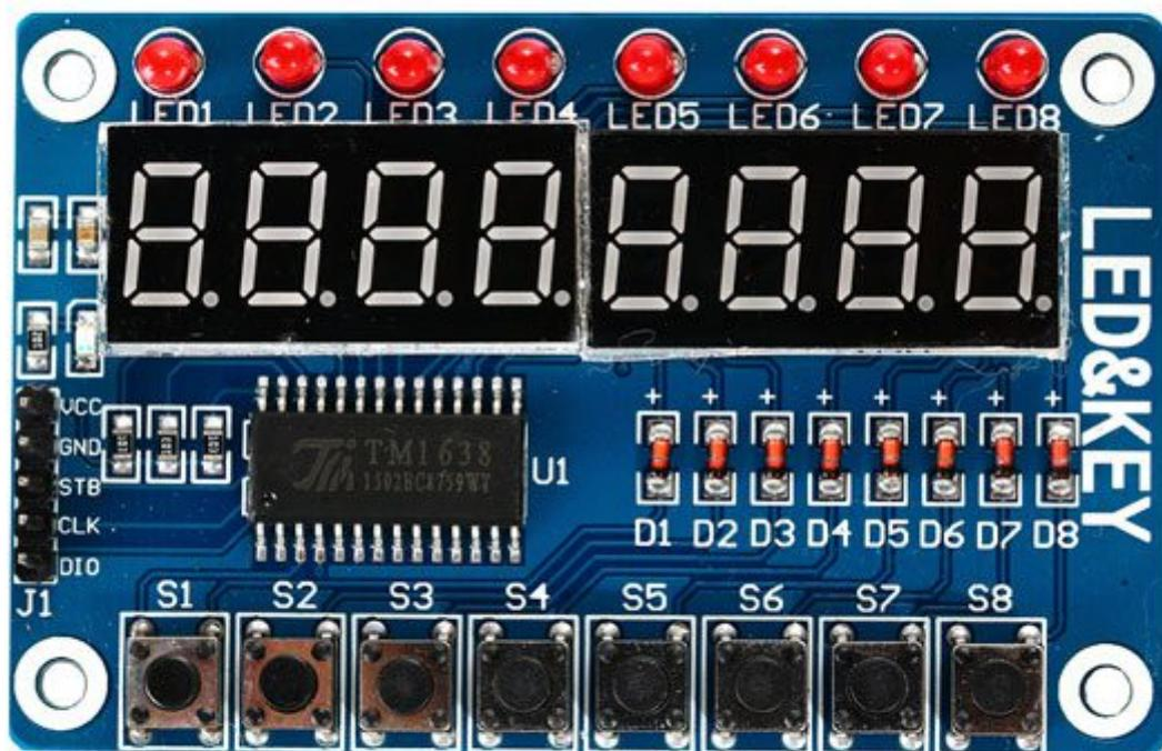
Basata sul chip TM1638 e particolarmente indicata per sperimentazione o altre applicazioni, questa scheda dispone di 2 display a 4 digit, 8 LED rossi da 3 mm, 8 pulsanti. Può essere controllata con solo 3 pin digitali di Arduino, Fishino o altro microcontrollore. Alimentazione: 5 Vdc, dimensioni (mm): 76,2x49,7x9,7, peso: 25 grammi. La confezione comprende la scheda e 5 jumper maschio-femmina.
