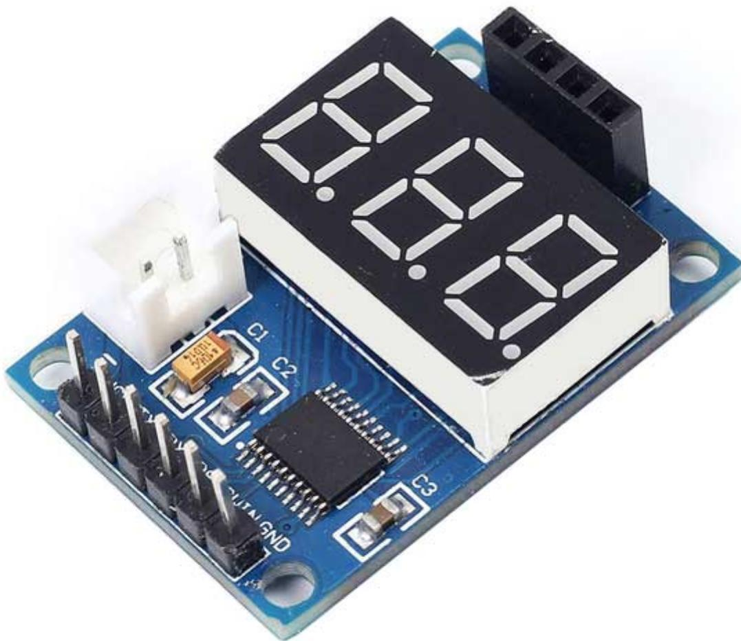
Abbinata al misuratore di distanza ad ultrasuoni (MISDIST04), questa compatta scheda visualizza sul suo display a 3 cifre, la distanza tra il sensore e l'ostacolo che si trova frontalmente (da 3 a 400 cm). È anche possibile collegarsi via seriale TTL a 9600bps e visualizzare sulla seriale la distanza rilevata. Il misuratore di distanza ad ultrasuoni è acquistabile separatamente (vedere prodotti correlati).
