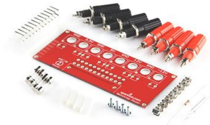
Questa scheda, abbinata ad un comune alimentatore ATX per PC, rende disponibili 4 differenti tensioni di uscita (3,3 V, 5 V, 12 V e -12 V) ciascuna con il proprio fusibile da 5 A (sostituibile).
