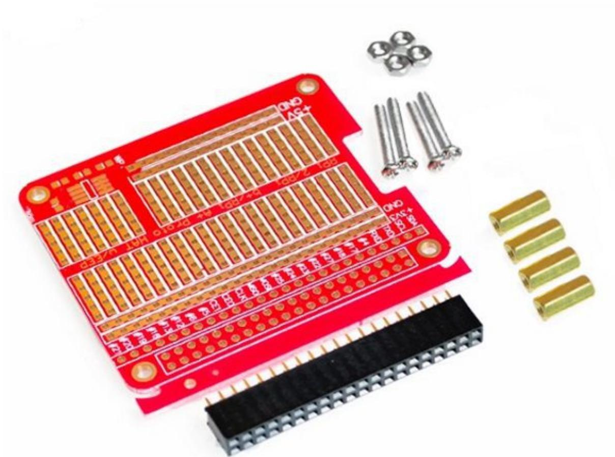
Piastra sperimentale realizzata appositamente per essere montata sulla board raspberry Pi tramite connettore GPIO 40 pin. Con questa shield sperimentale è possibile testare le proprie applicazioni senza dover realizzare un apposito circuito stampato. Minuterie, distanziali e viti compresi.
