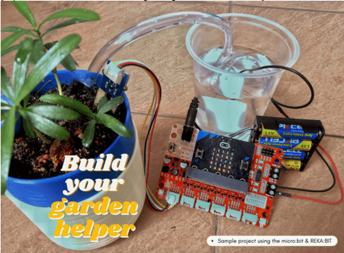
**Sistema di irrigazione automatica per piante**
