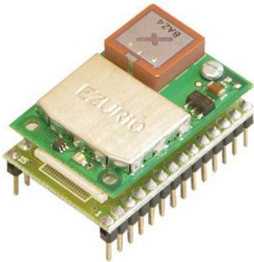
Scheda di supporto per il modulo bluetooth Ezurio (incluso) da utilizzare in abbinamento alla demoboard FT628K.
