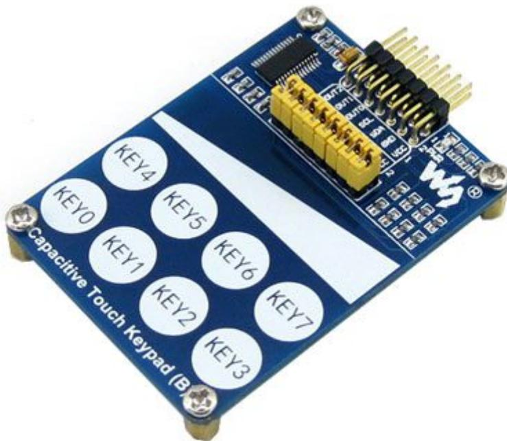
Basata sul chip TTP229-LSF, questa scheda permette di realizzare una piccola tastiera touch a 8/16 pulsanti e uno slider. Il sistema si ricalibra automaticamente quando nessuno dei pulsanti viene toccato per più 4 secondi.
