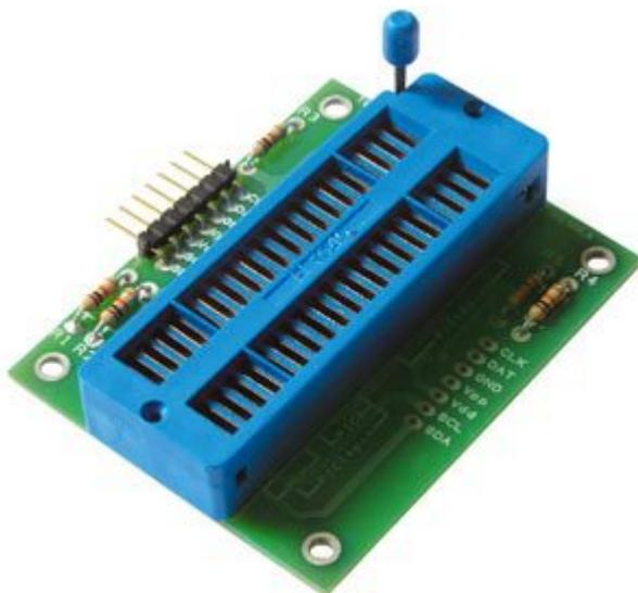
Semplice interfaccia di programmazione dotata di zoccolo Textool da abbinare al programmatore in-circuit USB FT650. Consente di programmare facilmente tutti i microcontrollori supportati dal programmatore, senza dover ricorrere alla programmazione in-circuit. L'impiego di uno zoccolo di tipo textool rende questa interfaccia ideale per chi esegue numerosi cicli di programmazione. Disponibile anche nella versione in kit **cod. FT652K**.
