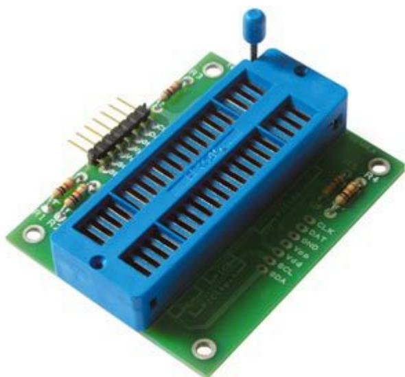
Semplice interfaccia di programmazione dotata di zoccolo Textool da abbinare al programmatore in-circuit USB FT650. Consente di programmare facilmente tutti i microcontrollori supportati dal programmatore, senza dover ricorrere alla programmazione in-circuit. L'impiego di uno zoccolo di tipo texttool rende questa interfaccia ideale per chi esegue numerosi cicli di programmazione. Disponibile anche nella versione già montata **cod. FT652M**.
