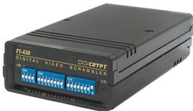
Sistema digitale di codifica video impiegato prevalentemente nel campo della sicurezza e della videosorveglianza. L'apparecchio può essere utilizzato sia come codificatore che come decodificatore. Possibilità di scegliere il tipo di codifica tra quattro differenti sistemi e di impostare un codice tra 65536 combinazioni differenti.
