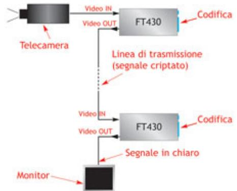
Trasmissione via cavo
