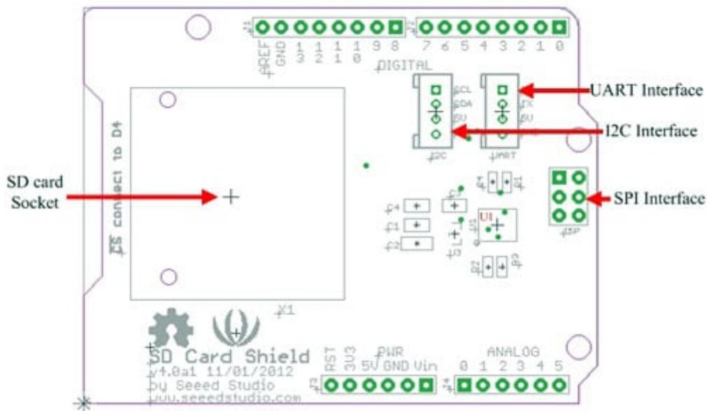
Shield per Arduino dotata di slot per SD Card e adattatore per micro SD. Ideale per applicazioni dove è necessario memorizzare molti dati, permette di leggere e scrivere le SD card con la libreria SD di Arduino. Supporta il formato FAT16 o FAT32, SD card max.16GB, Micro SD card max. 2GB e SDHC max. 16GB. Alimentazione: da 3,5 a 5,5 V (max), corrente: 100 mA (max. 200 mA), dimensioni: 68,7 x 53,5 x 19 mm e peso: 14,8 grammi.
