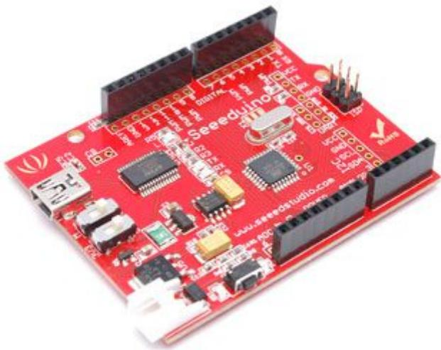
Seeeduino è una scheda compatibile con Arduino Duemilanove e basata sul microcontrollore ATmega328. La pinout, i fori di fissaggio e le dimensioni sono compatibili al 100% con quelle di Arduino. La scheda dispone di 14 I/O (di cui 6 possono essere utilizzati come uscite PWM), 8 ingressi analogici, 32 kB di memoria flash, 2 kB di SRAM e 1 kB di memoria EEPROM.
