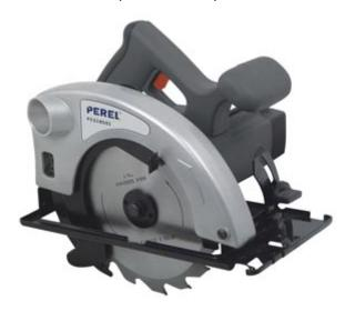
Sega circolare leggera con base d'appoggio metallica. Dotata di un dispositivo di bloccaggio dell'albero per una rapida sostituzione della lama. Regolazione veloce della profondità di taglio tramite leva anteriore. Particolarmente adatta al lavoro di falegnameria, taglia vari tipi di legno ad una profondità massima di 55 mm a 90° e di 38 mm a 45°.
