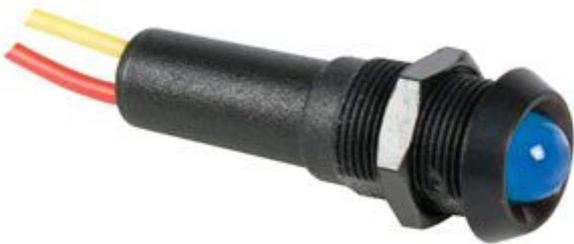
Led blu completo di portaled. Alimentazione 12 Vdc, portaled in ABS nero, fissaggio a vite.
