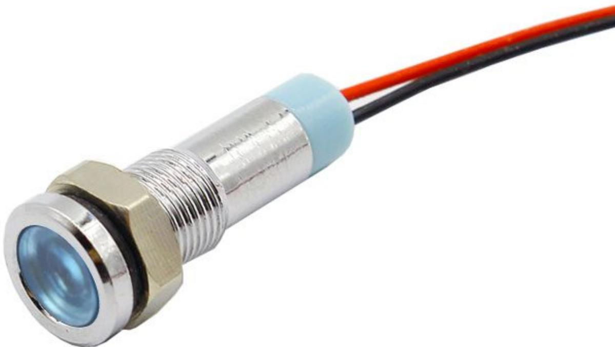
Segnalatore luminoso composto da un LED blu ad alta luminosità completo di portaled in metallo e cavetti di alimentazione. Alimentazione: 12-24 VDC, fissaggio a vite.
