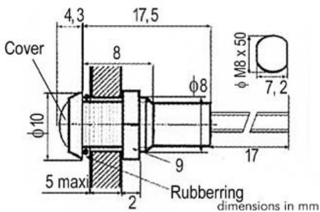
Led rosso lampeggiante completo di portaled a tenuta stagna. Alimentazione 12V, portaled di colore nero, fissaggio a vite.
