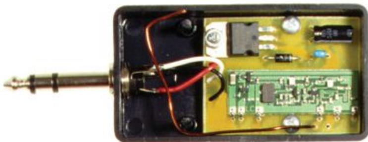
Scheda trasmittente radio per segnapunti elettronico. Grazie alla possibilità di collegare via radio la consolle al display, il sistema può essere installato rapidamente e senza alcun problema in qualsiasi palestra.
