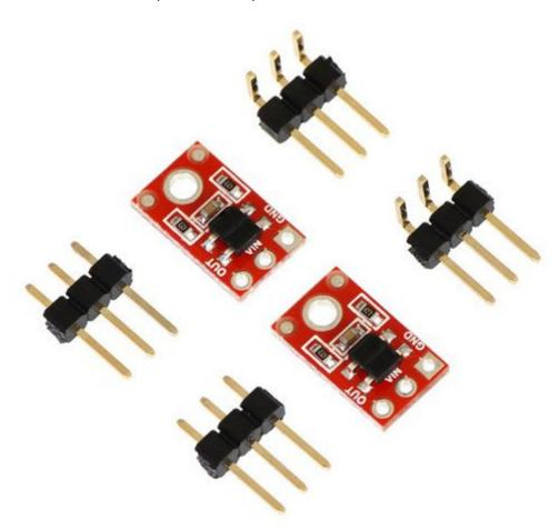
Sensore a riflessione composto da un diodo emettitore all'infrarosso e da un fototransistor. Il fascio emesso dal trasmettitore si riflette sulla superficie posta di fronte e colpisce il ricevitore mandando in conduzione il relativo fototransistor. La confezione comprende due sensori a riflessione, gli strip a 90° e dritti.
