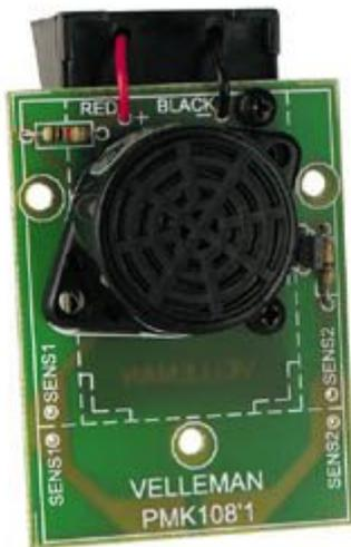
Emette un suono di allarme quando viene rilevata dell'acqua. Il cicalino di allarme è incluso. Il sensore acqua può essere posizionato a distanza tagliandolo dal circuito stampato e ricollegandolo con conduttori.
