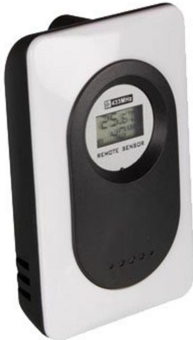
Sensore di temperatura e umidità con display LCD e trasmettitore radio a 433 MHz. Distanza di trasmissione 100 m. Il display mostra temperatura e umidità. Utilizza due pile a stilo da 1,5V tipo AAA (non incluse). Dimensioni (mm): 60x98x25, peso: 110 grammi. Utile come trasmettitore aggiuntivo o di ricambio per la stazione meteo 8220-WS8737.
