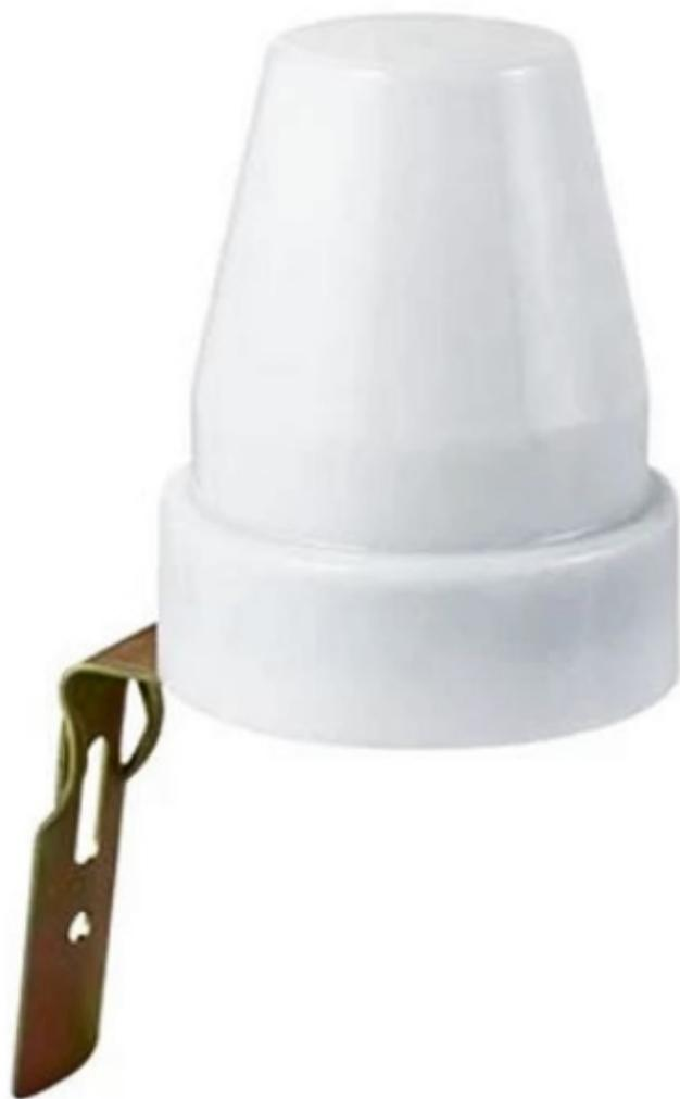
Sensore crepuscolare con grado di protezione IP44. Consente l'attivazione di un dispositivo, funzionante a 220 Vac, al sopraggiungere della sera e alla loro disattivazione quando rileva la luce del giorno. Dispone di staffa metallica per l'installazione e tre fili per il collegamento lunghi circa 14 cm.
