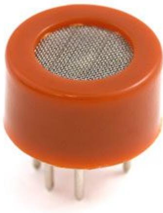
Questo sensore è in grado di rivelare la concentrazione di alcool nel sangue attraverso il respiro, proprio come un comune etilometro. Ha una elevata sensibilità e un tempo di risposta molto rapido. Il sensore fornisce in uscita un valore di resistenza basato sulla concentrazione di alcool. Il circuito di controllo è molto semplice, tutto ciò di cui avete bisogno è di una resistenza.
