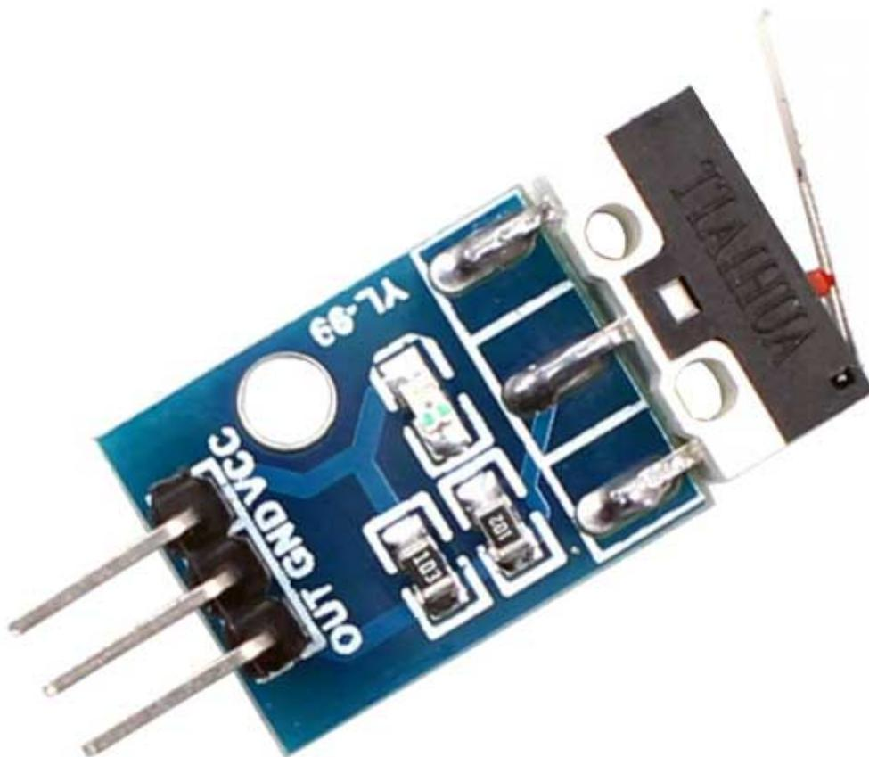
Costituita da un micro switch e un LED di stato, questa piccola scheda è particolarmente indicata per essere utilizzata come sensore anticollisione per robot. Dispone di un foro di fissaggio M3. Completa di cavetto lungo circa 20 cm con relativi connettori per VCC, GND e OUT. Lo stato dell'uscita OUT è normalmente alta se non c'è collisione (micro switch aperto), mentre è bassa se c'è collisione (micro switch chiuso). Dimensioni (mm): 25x13,5x7.
