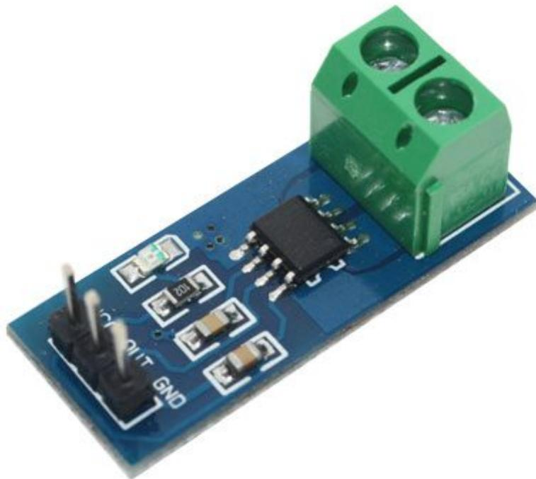
Basato sul chip ACS712ELCTR-05B-T dell'Allegro, questo sensore di corrente è in grado di rilevare valori di corrente AC o DC compresi tra 0 e 5 A. Dispone di 3 pin (alimentazione e uscita analogica) e un morsetto a 2 poli al quale verrà collegato il carico come un tradizionale amperometro. Sull'uscita sarà presente un valore di 185 mV per ogni Ampere letto e 2,5 V se la corrente è pari a zero. Alimentazione: 5 Vdc, Vout: 185 mV/A, range di misura: da 0 a 5 A.
