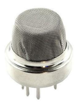
Sensore in grado di rilevare la presenza di gas naturale nell'aria (composto principalmente da metano) in concentrazioni comprese tra 300 e 10.000 ppm. Dispone di una elevata sensibilità e tempi di risposta molto rapidi. Il circuito di comando è molto semplice; tutto quello che dovete fare è fornire 5V, aggiungere una resistenza di carico e collegare l'uscita ad un convertitore AD.
