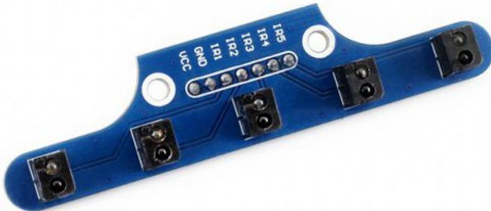
Sensore di linea composto da 5 fotointerruttori a riflessione ad alta sensibilità. Sono disponibili 5 uscite analogiche, che interfacciate ad Arduino, Raspberry o altro microcontrollore, consentono al robot di seguire una linea in modo più stabile. Range di rilevamento: da 1 cm a 5 cm, alimentazione: da 3,3 V a 5 V, dimensioni (mm): 78x18.
