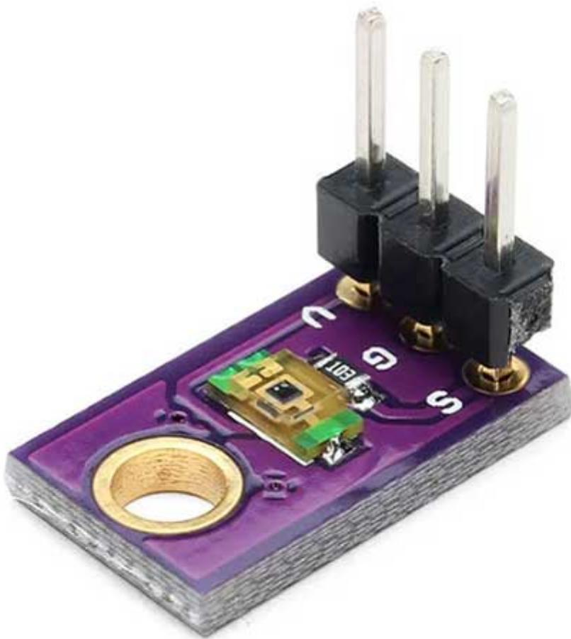
Questo modulo utilizza il sensore di luce **TEMT6000**, progettato per rilevare la luce nell'ambiente circostante. Con una massima sensibilità a 570 nanometri e un ampio angolo di rilevamento di 60 gradi, il sensore si concentra sulla luce visibile, filtrando gli spettri infrarossi (IR), simile alla capacità dell'occhio umano.
