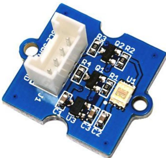
Compatto modulo Grove basato sul sensore TLS2561. Dotato di interfaccia I2C, questo modulo è in grado di trasformare l'intensità della luce in un segnale digitale. È possibile selezionare tre modalità di rilevazione (tutto lo spettro, infrarossa o visibile), ciascuna con un indirizzo I2C diverso. Può essere interfacciato a qualsiasi microcontrollore, anche se non dispone di ingressi analogici.
