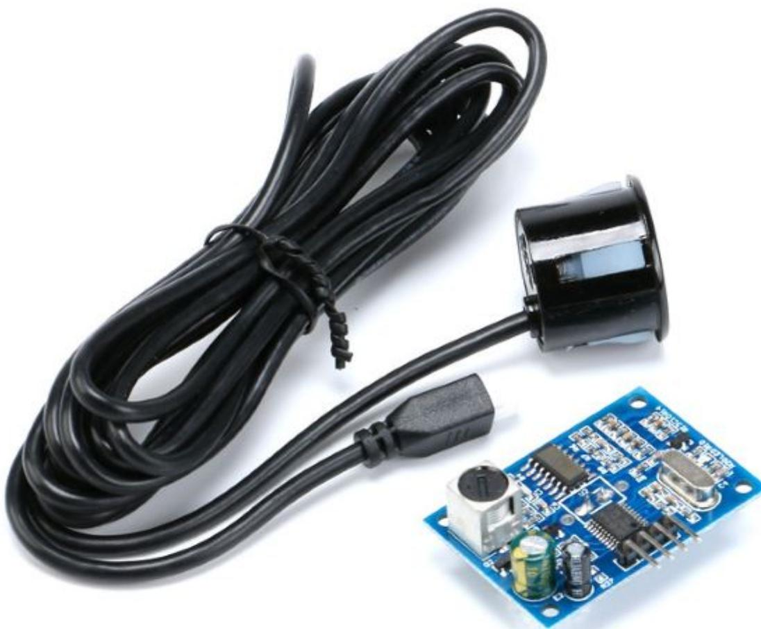
Modulo sensore a ultrasuoni in grado di rilevare la distanza fino a 4,5 metri con una precisione di 0,5 cm Capsula a ultrasuoni a 40 Khz impermeabile con cavo di collegamento di oltre 2 metri.
