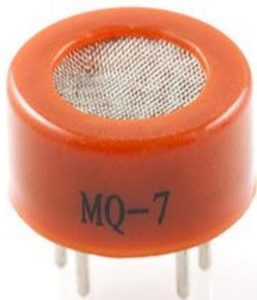
Sensore in grado di rilevare la presenza di Monossido di Carbonio (CO) nell'aria in concentrazioni comprese tra 20 e 2.000 ppm. Dispone di una elevata sensibilità e tempi di risposta rapidi. Il circuito di comando è molto semplice; tutto quello che dovete fare è fornire 5V, aggiungere una resistenza di carico e collegare l'uscita ad un convertitore AD.
