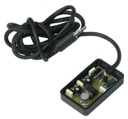
Semplice e versatile circuito che permette di rilevare quando un veicolo o un qualsiasi altro oggetto compie dei movimenti. Tramite due trimmer è possibile impostare la sensibilità del dispositivo e il tempo di attivazione dell'uscita del circuito a seguito di uno spostamento. Il kit comprende tutti i componenti, la basetta forata e serigrafata, il rilevatore di movimento al gas di mercurio, il contenitore, uno spezzone di cavo e il connettore jack stereo.
