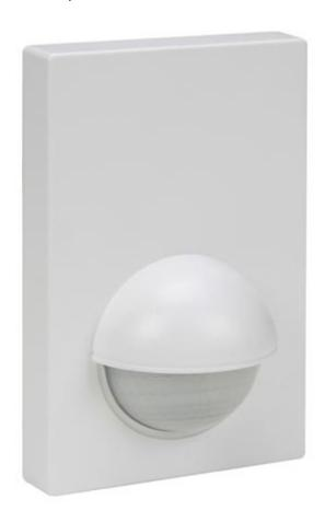
Sensore di movimento ad infrarossi passivi, in grado di attivare al passaggio di una persona, una lampada per un periodo di tempo regolabile tra 10 secondi e 7 minuti. Identificazione automatica giorno/notte, massimo carico controllabile: 1200 W (lampade alogene) / 300 W (lampade a risparmio energetico). Alimentazione: 220 - 240 Vac / 50 Hz.
