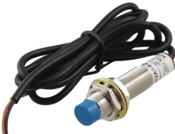
Particolarmente indicato come finecorsa senza contatto, questo sensore di prossimità è in grado di rilevare un oggetto metallico ad una distanza massima di 4 mm. L'uscita del sensore è di tipo NPN (Open Collector), dove l'uscita viene portata a massa, dando la possibilità di chiudere un circuito esterno. Alimentazione: da 6 a 36 Vdc, corrente NPN: max 200 mA, dimensioni (mm): 61 (lunghezza) x 12 (diametro), peso: 44 grammi, lunghezza del cavo: circa 115 cm.
