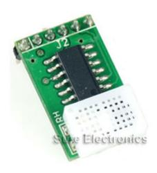
Questo sensore, completamente calibrato e con uscita digitale SPI, permette di misurare temperature comprese tra -40°C e +70°C e umidità relativa dal 10% al 98%. È dotato di elevata precisione, eccellente stabilità e trasferimento dati ad alta velocità. È particolarmente adatto per prodotti di consumo, stazioni meteo, applicazioni HVAC (<u>Heating, Ventilation and Air Conditioning</u>), ecc. Dimensioni: 19 mm (lunghezza) x 12 mm (larghezza) x 10,80 mm (altezza), peso: 30 grammi.
