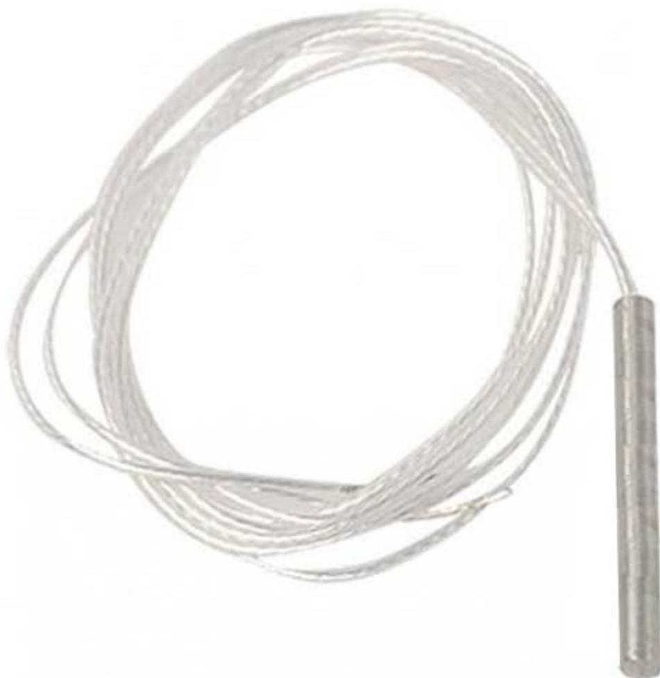
Molto stabile e precisa, la sonda di temperatura [PT100](#) (ovvero termoresistenze in platino) consente di misurare una temperatura in un range da  $-50^{\circ}\text{C}$  a  $+450^{\circ}\text{C}$  con una precisione di circa  $0,5^{\circ}\text{C}$  (da  $-10^{\circ}\text{C}$  a  $+85^{\circ}\text{C}$ ). Questo tipo di sonda ha una resistenza di 100 ohm alla temperatura di  $0^{\circ}\text{C}$ . Il valore della resistenza varia al variare della temperatura.
