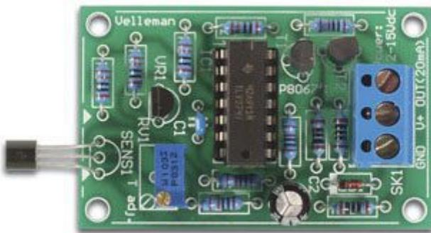
Sensore di temperatura per impieghi generali in grado di rilevare temperature comprese tra -20°C e +70°C. Facilmente interfacciabile con dispositivi di controllo, condizionamento e riscaldamento.
