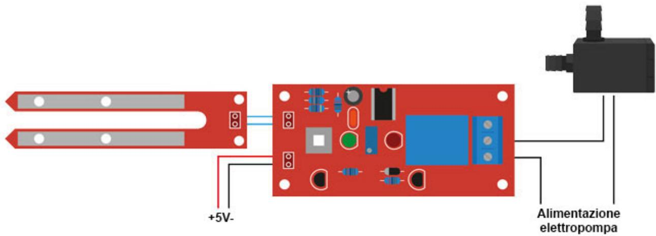
Cablaggio del circuito per controllare una pompa normalmente a riposo, che si attiva al verificarsi dello stato di allarme.[/caption]
