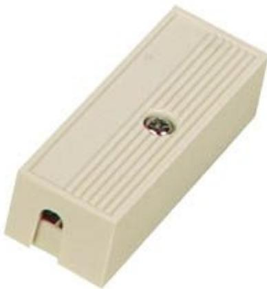
Sensore di vibrazione da installare su porte e finestre. Permette di segnalare il tentativo d'intrusione prima che l'apertura sia stata forzata attivando l'allarme ad esso collegato. Possibilità di regolazione della sensibilità mediante apposita vite.
