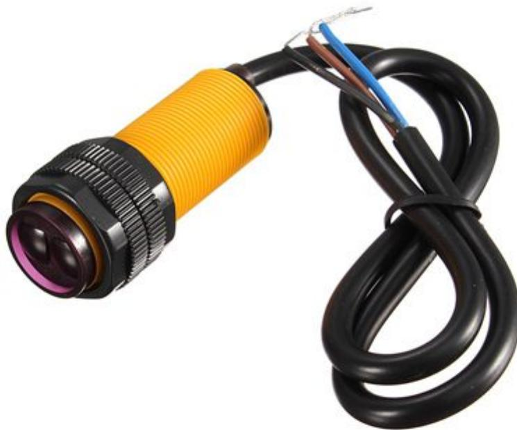
Sensore di prossimità formato da un emettitore di infrarossi modulato da un segnale ben preciso e da un ricevitore costituito da un fotodiode sensibile alla banda emessa dall'emettitore. L'elettronica rileva come segnale utile quello modulante, rendendo questa misura insensibile ai "rumori" esterni quali la luce ambiente e tutte le emissioni non volute anche nello spettro degli infrarossi, che possono manifestarsi nelle vicinanze dei fotodiode ricevitori.
