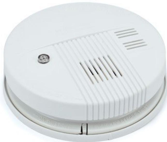
Sensore di fumo wireless per centrale antifurto FR522. Installato nei soffitti della vostra casa rileva la presenza di fumo, ed invia un segnale di allarme via radio alla centrale. Dotato di spia per il controllo del funzionamento. Alimentazione: batteria 9V 6LR61 (inclusa), dimensioni: Ø 110 x H 35 mm.
