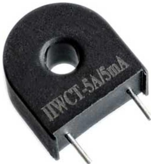
Sensore induttivo monofase che permette di misurare una corrente alternata (max. 5 A) che attraversa un cavo, semplicemente facendolo passare attraverso il foro del sensore. In uscita si avrà una corrente ridotta di circa 1000 volte rispetto a quella che attraversa il cavo (esempio: per una corrente di 5 A si avranno 5 mA in uscita).
