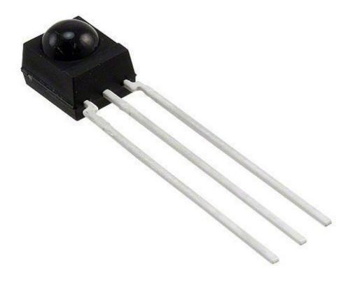
Sensore infrarossi con amplificatore, demodulatore e filtro tarato sulla frequenza di 38 KHz. Uscita attiva a livello basso, alimentazione compresa tra 2,5 e 5,5 volt, assorbimento 5 mA, temperatura di lavoro: da -25°C a +85°C. Può essere utilizzato come sensore di presenza e prossimità, rilevatore ostacoli in robotica, ecc.
